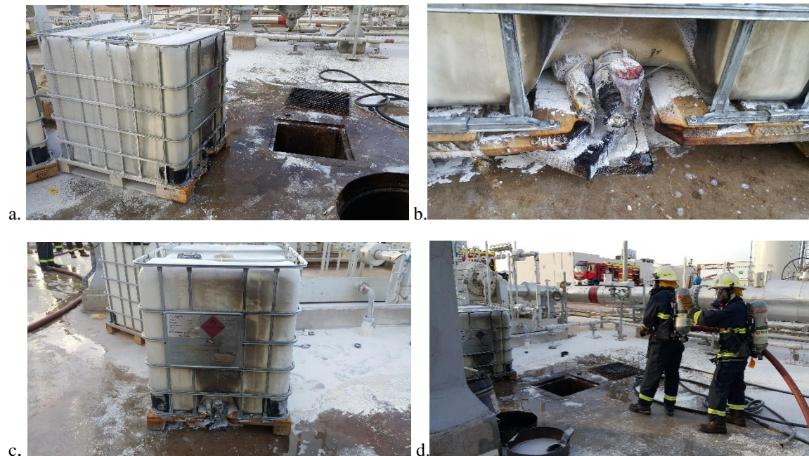
Slika 5. Gašenje požara rezervoara: a) RIBC i otvor sistema odvoda, b) Žarište požara na česmi rezervoara, c) Blizina drugog RIBC rezervoara i prepoznatljivi V-oblik izvora požara, d) Blizina sistema cjevovoda
